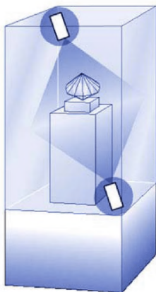
Рисунок 15 – Пример установки ультразвукового извещателя «Витрина» в охраняемом хранилище ценностей (витрине)
