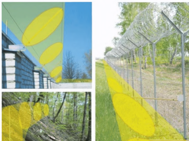
Рисунок 2.12 – ЗО проводноволнового извещателя
