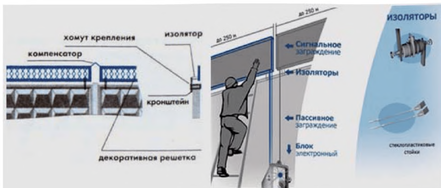
Рисунок 2.2 – Установка ЧЭ емкостного СО
