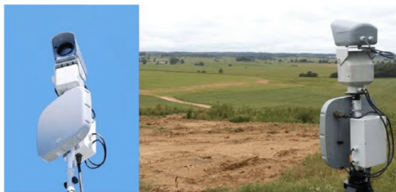
Рисунок 2.55 – Внешний вид РЛС «Радескан» в комплексе с тепловизором фирмы «DALI», модель S660-3-100
