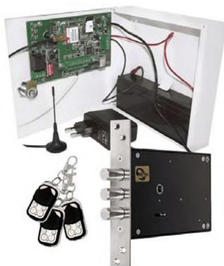
Замок имеет три мощных цилиндрических запорных ригеля, работает по принципу моторного замка, не имеет внешних признаков установки в двери, что значительно затрудняет несанкционированное вскрытие двери механическими способами взлома.
