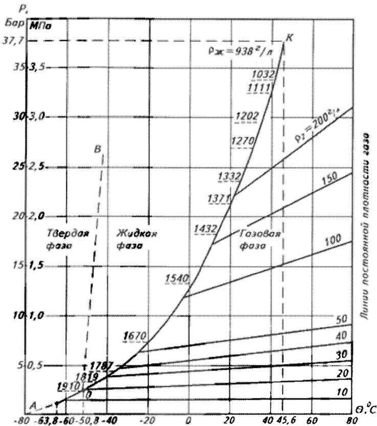
Рисунок 1 – Пример диаграммы зависимости давления и плотности элегаза от температуры
