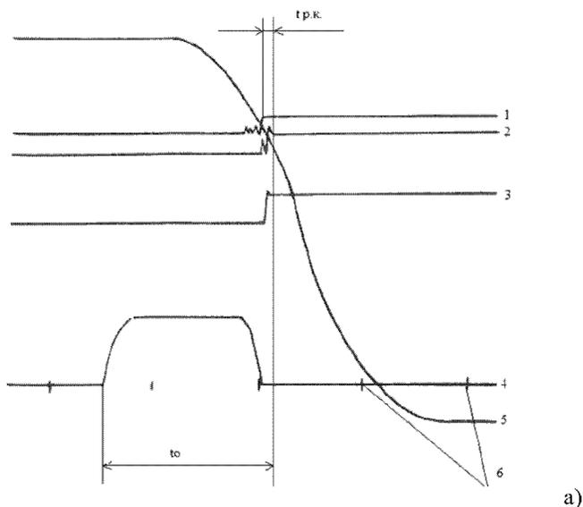
Рисунок 12 - Осциллограммы работы выключателя ВГБУ-220
