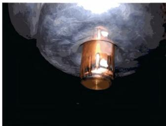
Рисунок 3 - нагрев контактного соединения в соединительном элементе
