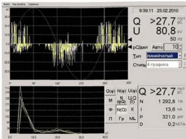
Дефект типа мелких частиц, максимальное число импульсов в секунду ~34 имп/с с амплитудой 20 пКл
