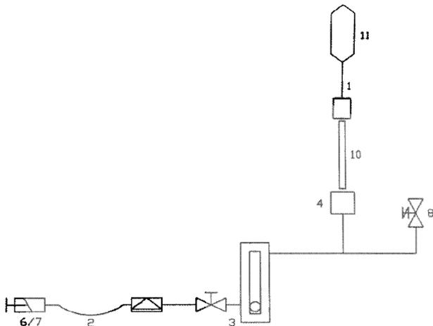
Рисунок 15 - Газовая схема устройства для контроля содержания продуктов разложения
