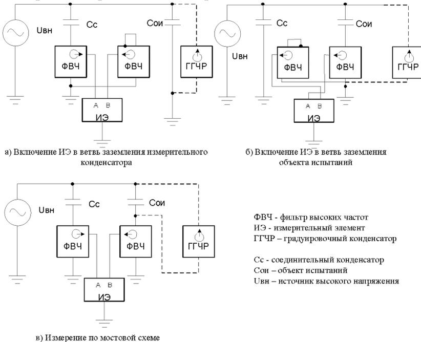
Рисунок 5 - Схемы контроля ЧР при испытаниях
