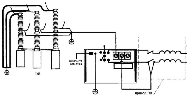
Рисунок 11 - Подключение прибор анализа временных характеристик выключателей к отдельстоящему ЭВ (показано в состоянии после снятия заземления с одной стороны ЭВ). Заземления показаны на момент подготовки измерительной схемы к проведению измерений.
