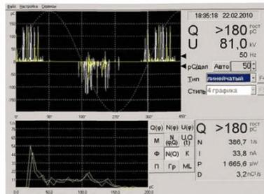
Предполагаемый дефект твердой изоляции порядка 800 пКл с числом 2имп/с
