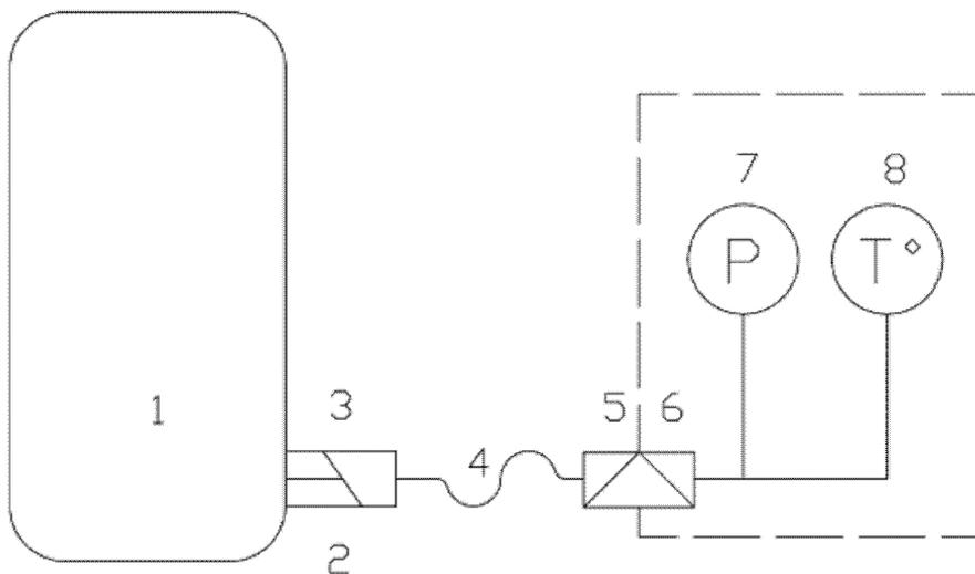
Рисунок 2 - Газовая схема измерения давления заполнения газоизолированных отсеков ЭО
