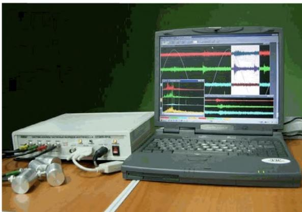
Рисунок 6 - Система анализа ЧР акустическая с портативным компьютером
