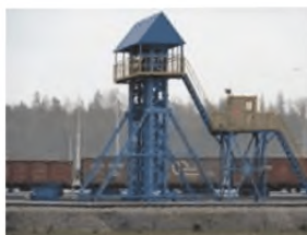
Бурильная установка для рыхления угля в вагоне
