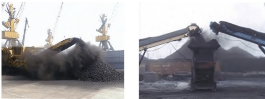
Рисунок 68 – Операции по приведению угля в транспортабельное состояние на ДСК могут сопровождаться обильным пылением
