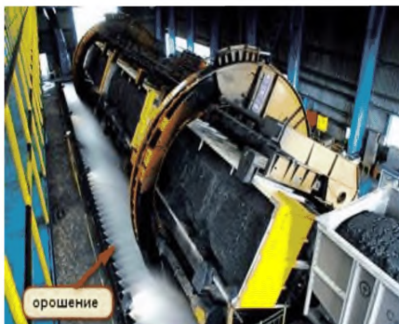
Рисунок 76 – Пылеподавление в СРВ
