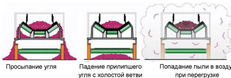
Просыпание угля Падение прилипшего угля с холостой ветви Попадание пыли в воздух при перегрузке Рисунок 57 – Пути попадания пыли в воздух при перемещении угля ленточным транспортером
