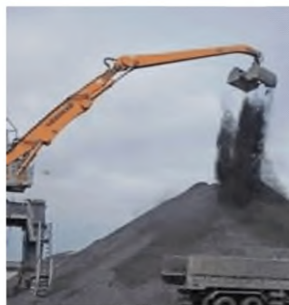
Рисунок 62 – Гидравлический перегружатель (ГП) с шарнирным подвесом грейфера на гусеничном шасси
