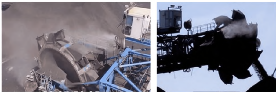
Рисунок 78 – Пылеподавление на рабочих органах стакеров и реклаймерах
