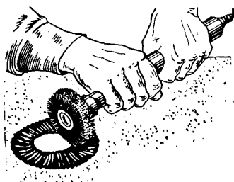
Рис. 31. Шероховка поврежденного места обкладки ленты.
