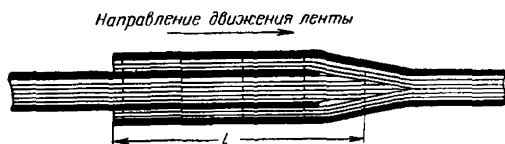
Рис. 17. Соединение концов ленты в паз.
