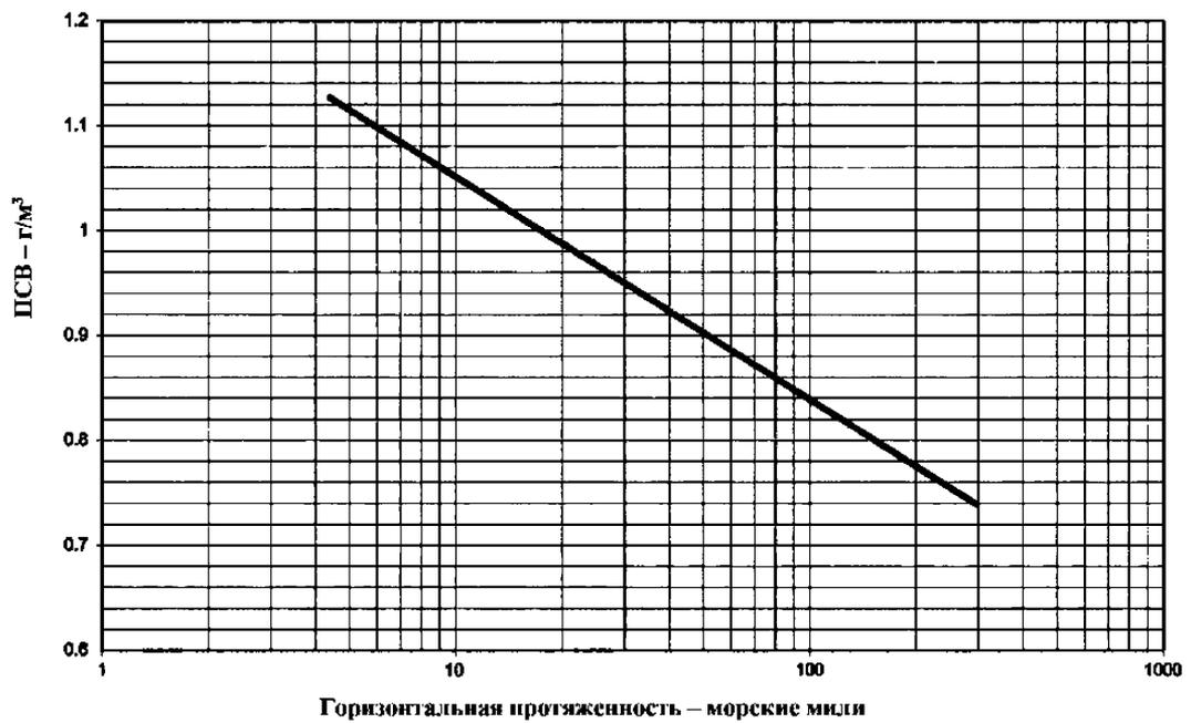
**Рис. D3 – Влияние протяженности воздействия на ИСВ**
