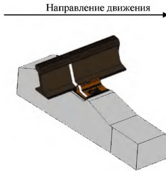
Рисунок 3.32 «Маячная» шпала для контроля угона пути для подкладочных креплений КБ-65, ЖБР-65ПШМ, ЖБР-65ПШ
