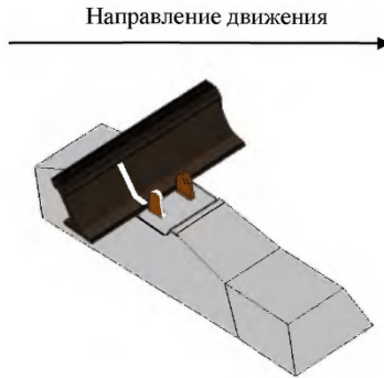
Рисунок 3.34 «Маячная» шпала для контроля угона пути для анкерных креплений
