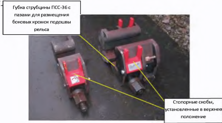
Рисунок 3.36. Одинарная (шириной 70 мм) и двойная (шириной 140 мм) струбцины ПСС-36
