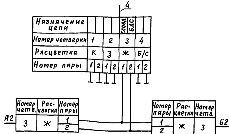
Монтаж муфты М2
