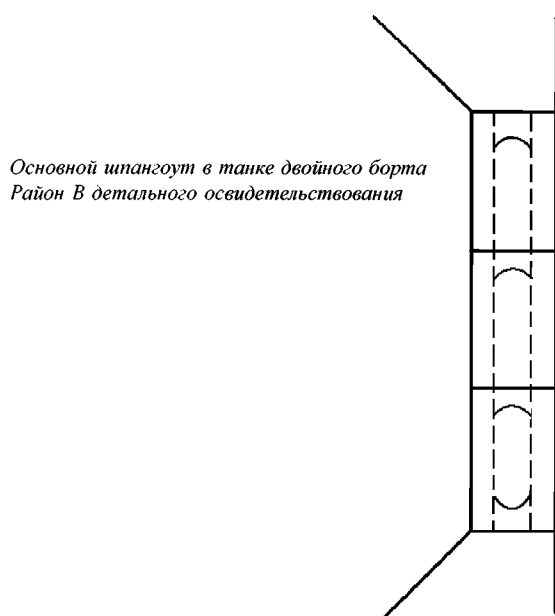
Рис. 6.2.3.2-1 Район В детальных освидетельствований навалочных судов
