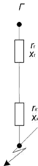
Рис.8.2.2 Схема замещения для расчета тока к.з. генератора в ЭЭС с полным распределением электроэнергии на постоянном токе
