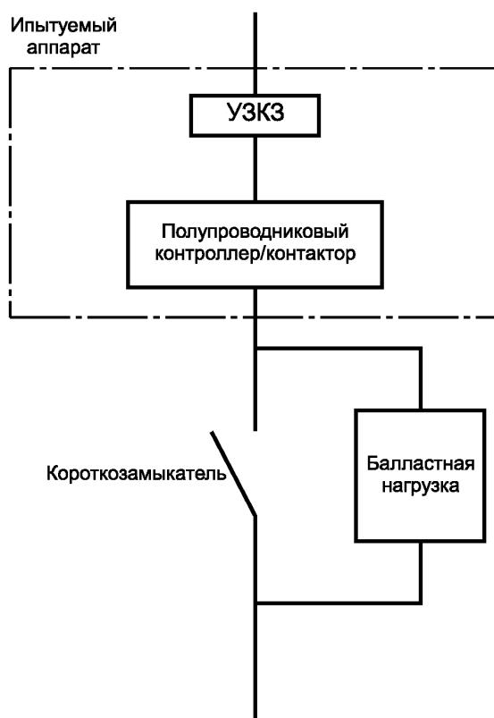
Рисунок I.1 — Модифицированная цепь для испытания на короткое замыкание полупроводниковых устройств
