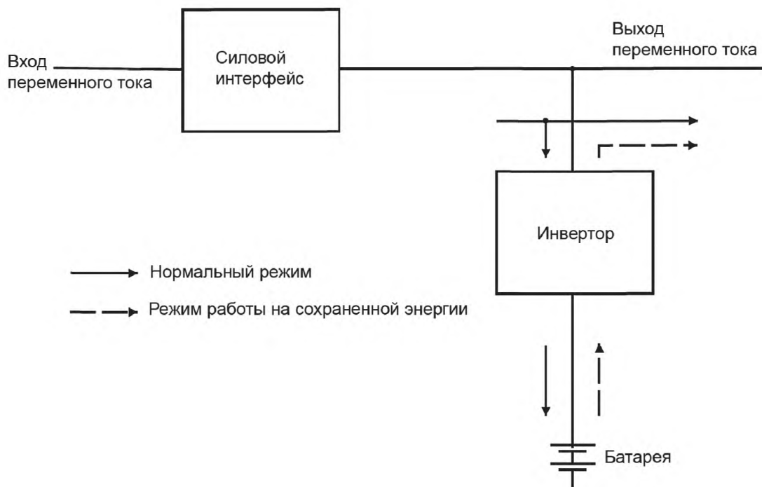
Рисунок В.2 — Линейно-интерактивная топология
