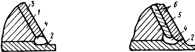
Рисунок 3. Схема выполнения предварительной наплавки кромок деталей из двухслойных сталей с плакирующим слоем, содержащим ниобий:
