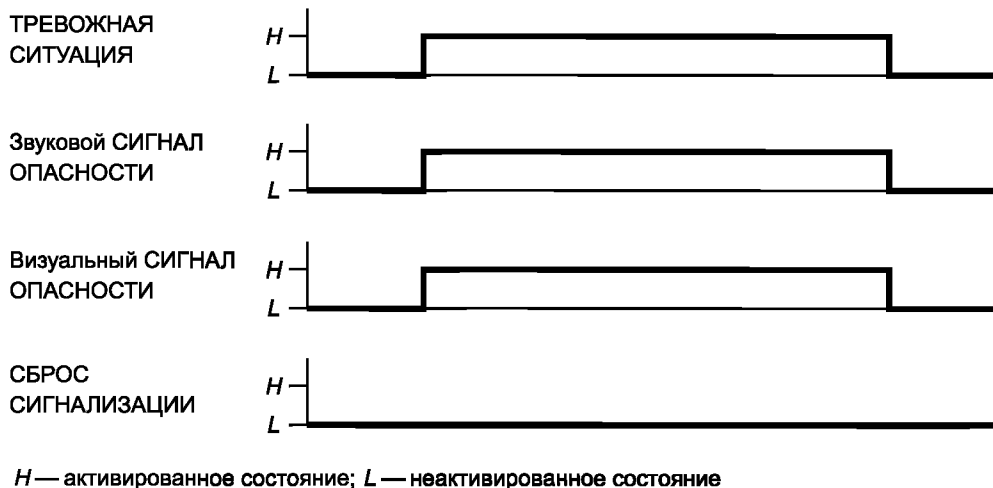
Рисунок ВВ.1 — НЕФИКСИРОВАННЫЕ СИГНАЛЫ ОПАСНОСТИ без СБРОСА СИГНАЛИЗАЦИИ
