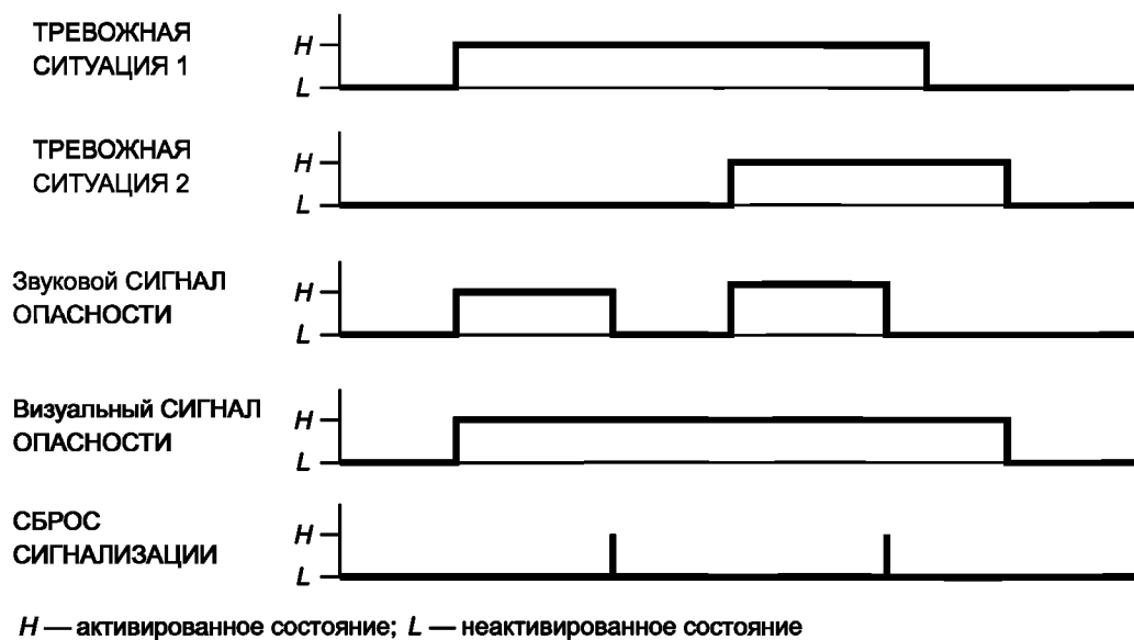
Рисунок ВВ.4 — Две ТРЕВОЖНЫЕ СИТУАЦИИ и СБРОС СИГНАЛИЗАЦИИ
