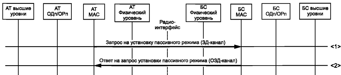
Рисунок 61 — Процедура «Переход в пассивный режим 2»
