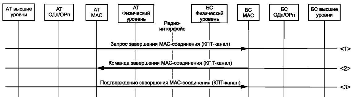
Рисунок 58 — Процедура «Завершение соединения MAC-подуровней по инициативе АТ»
