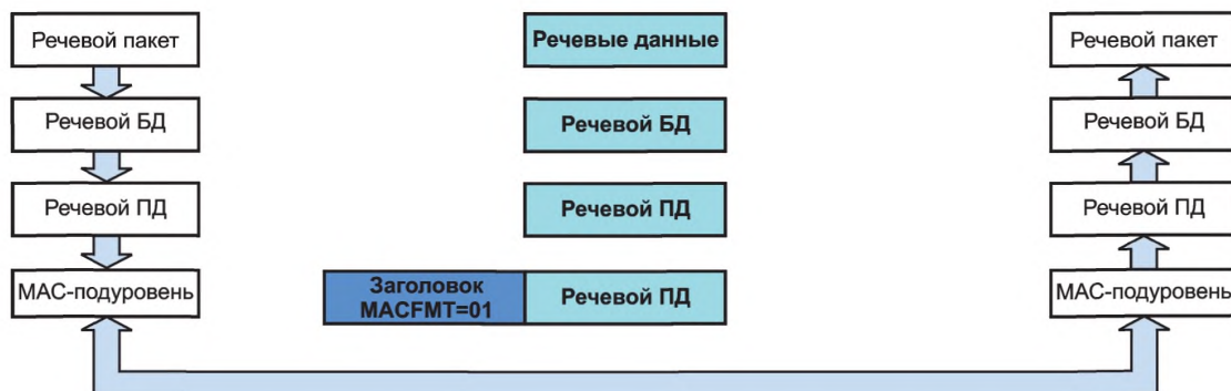
Рисунок 33 — Процесс формирования блоков данных (БД) и пакетов данных (ПД) на ОРп-подуровне
