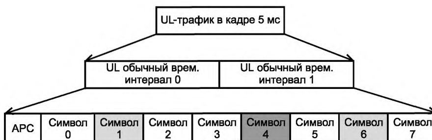
Рисунок 17 — Структура тайм-слотов в кадре трафика в UL длительностью 5 мс
