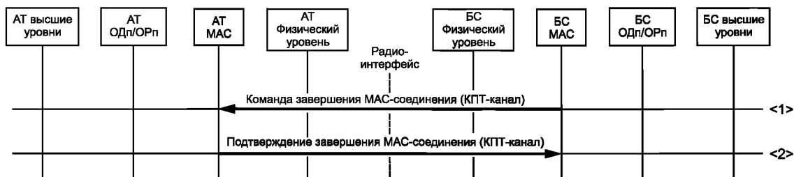
Рисунок 59 — Процедура «Завершение соединения MAC-подуровней по инициативе БС»
