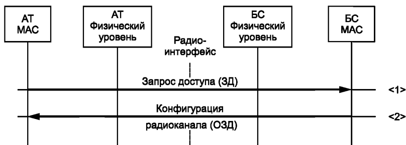
Рисунок 42 — Процедура «Запрос доступа»
