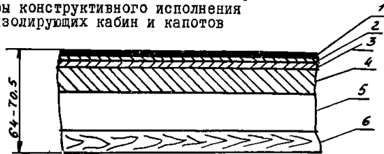
Черт. 1. Перегородка с усиленной звукоизоляцией 1-слой мастики (2-3 мм), 2-стальной лист (1,5 мм), 3-термозумовой картон ТШК-2 (2,5- 5,0 мм), 4-звукопоглощающий материал (20мм), 5-воздушный промежуток (30-40 мм), 6-древесно- стружечная плита или пластик (8-10 мм)
