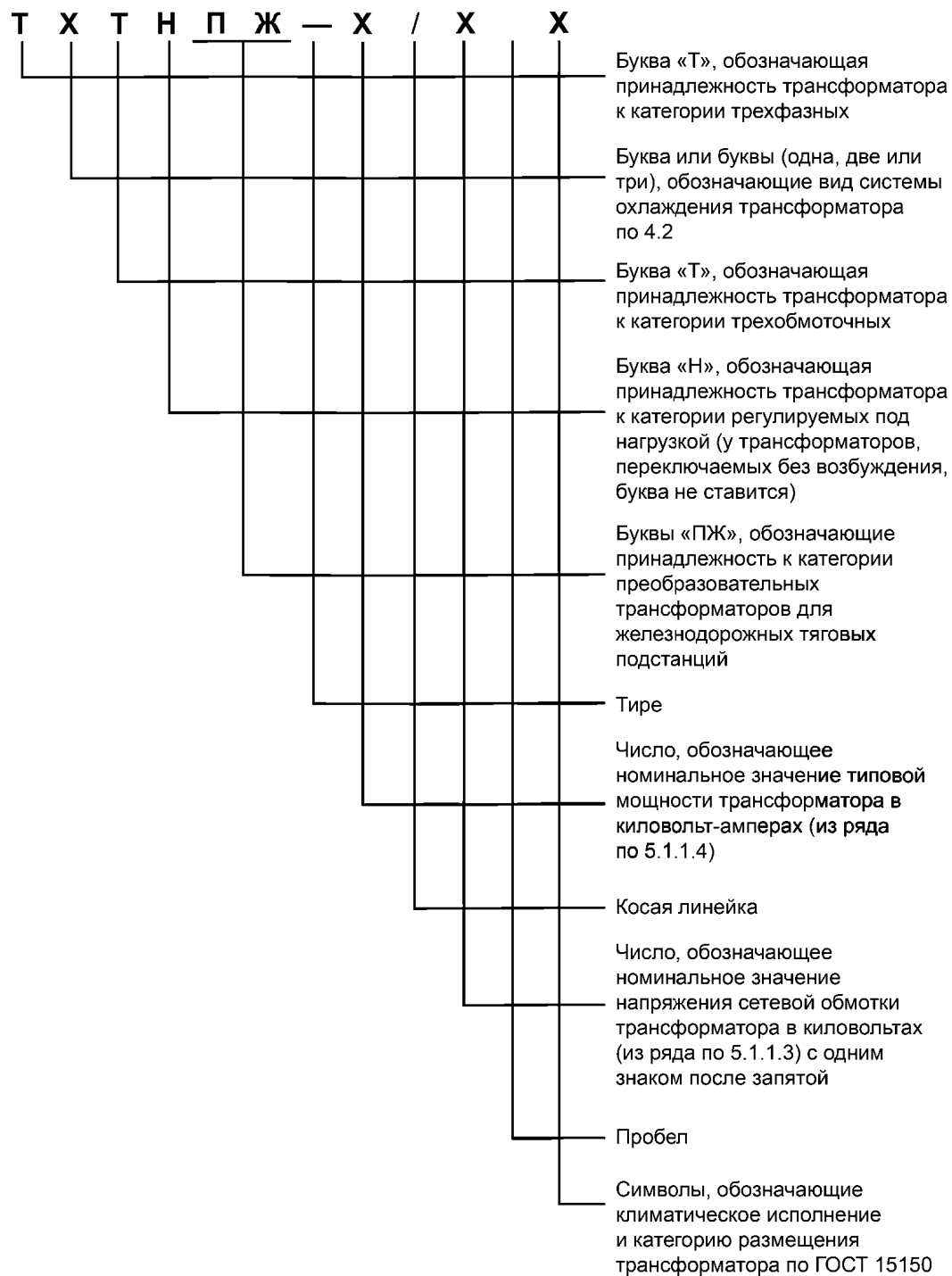
Рисунок 1 — Структурная схема условного обозначения трансформатора
