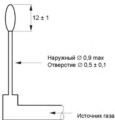
Рисунок 1а – Регулировка пламени
