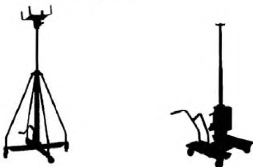
Рисунок 5 – Примеры гидравлических трансмиссионных домкратов
