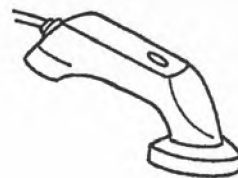
Шлифовальная машина с дельта-диском
