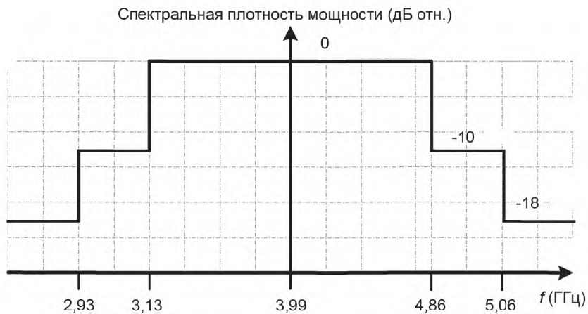
Рисунок 15 — Маска спектра передаваемого сигнала для канала 4
