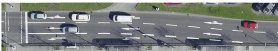
б) 1-я полоса – совмещенного прямого и правоповоротного движения, 2-я полоса – выделенная только для прямого движения, 3-я полоса – выделенная только для левоповоротного движения
