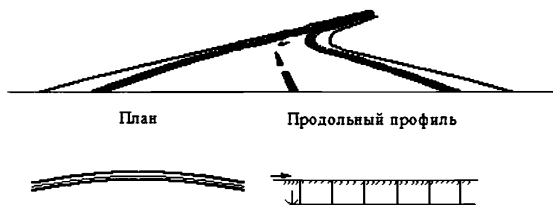
Рисунок Ж.11 – Нарушение зрительной плавности дороги прямой вставкой в плане
