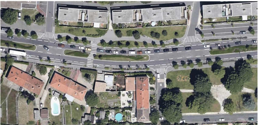
Рисунок Ф.8– Магистральная улица районного значения (распределительная) с двумя полосами движения и широкой разделительной полосой с выделением в ее разрывах дополнительной полосы для левых
