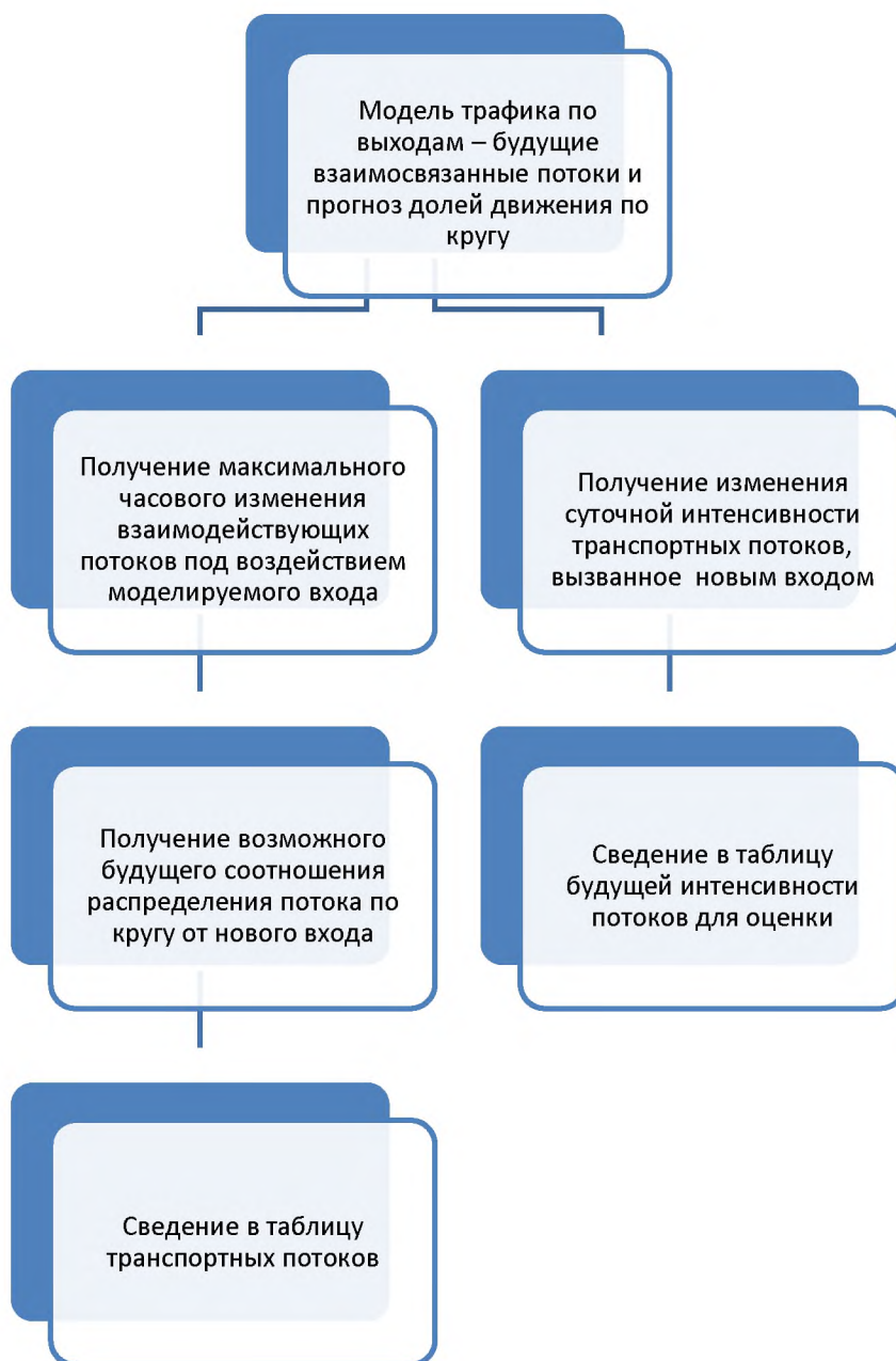
Рисунок С.3 – Порядок анализа интенсивности транспортного потока
