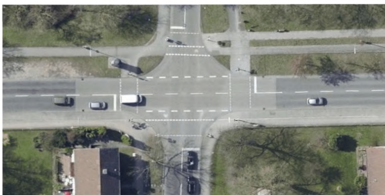
а) на каждом из подходов к пересечению одна полоса совмещенного прямого, левоповоротного и правооборотного движения
