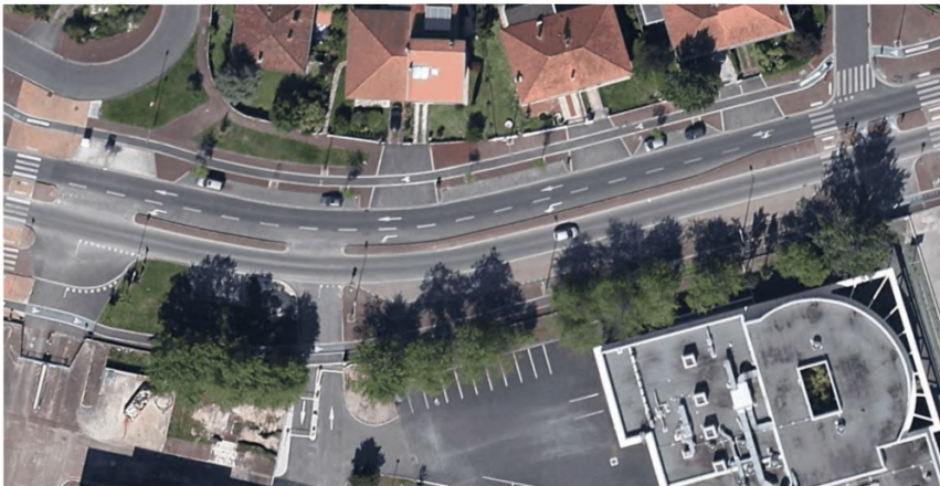
Рисунок Ф.9 – Устройство деленной полосы для левых поворотов в габаритах разделительной полосы. При ожидании разрыва в потоке противоположного направления совершающие левый поворот транспортные средства не блокируют полосу движения
