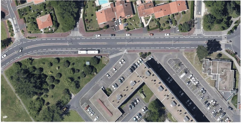
Рисунок Ф.7 – Магистральная улица районного значения (распределительная) с двумя полосами движения и разделительной полосой с разрывами для левых поворотов. При ожидании разрыва в потоке противоположного направления совершающие левый поворот транспортные средства блокируют полосу движения
