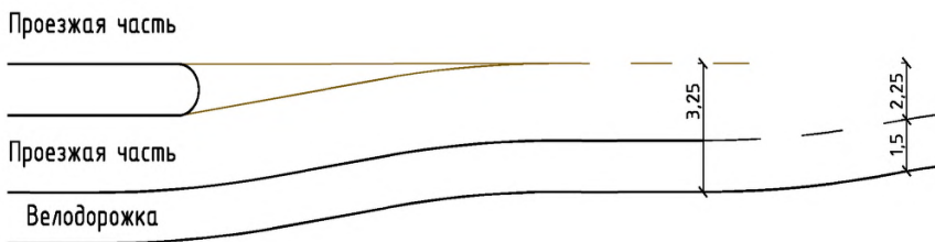
Рисунок Л.3 – Пример окончания велосипедной дорожки
