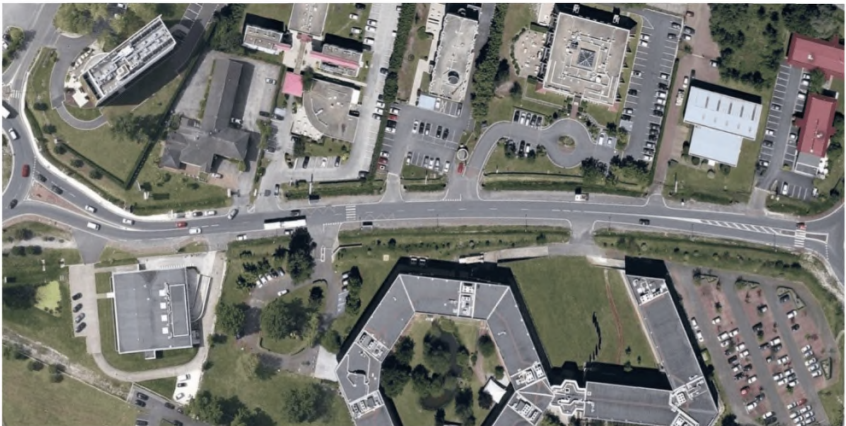
Рисунок Ф.6 – Местная улица с двумя полосами движения. Доступ с левым поворот с перегона улицы ограничен лишь только на подходах к пересечениям. При ожидании разрыва в потоке противоположного направления совершающие левый поворот транспортные средства блокируют полосу движения
