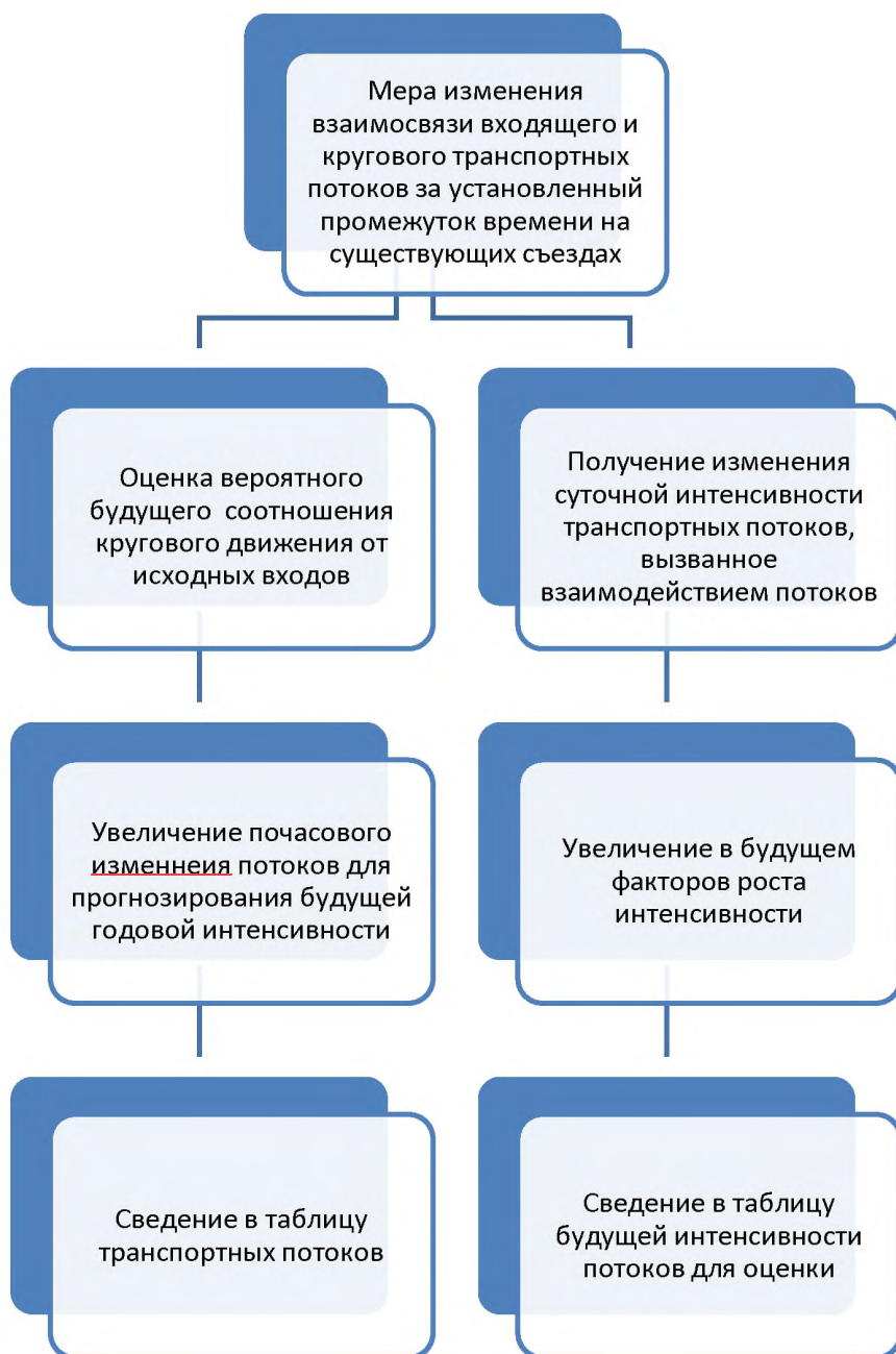
Рисунок С.4 – Порядок анализа пропускной способности
