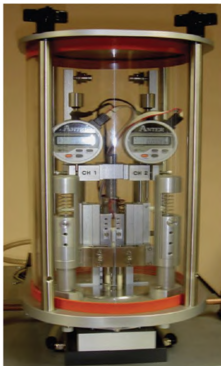
Рисунок А.2 — Конструкция блока индикаторов
