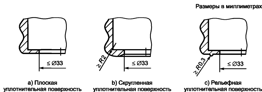
Рисунок 2 — Уплотнительная поверхность соединителя с наружной резьбой
