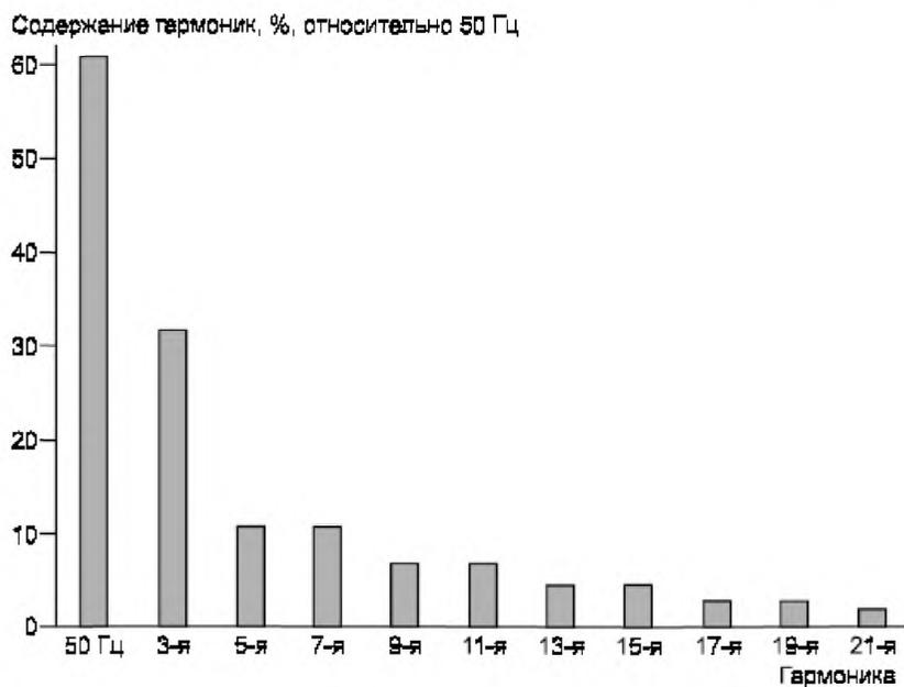
Рисунок А.6 — Распределение гармоник при фазовом управлении (анализ Фурье не завершен)
