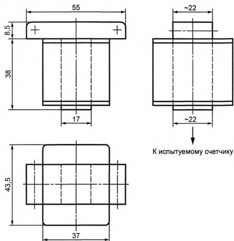
Примеры обмотки- 500 витков проволоки диаметром 0,6 мм сечением 0,28 мм<sup>2</sup> или 1000 витков проволоки диаметром 0,4 мм, сечением 0,126 мм<sup>2</sup>. Удельные потери 1 Вт/кг.
