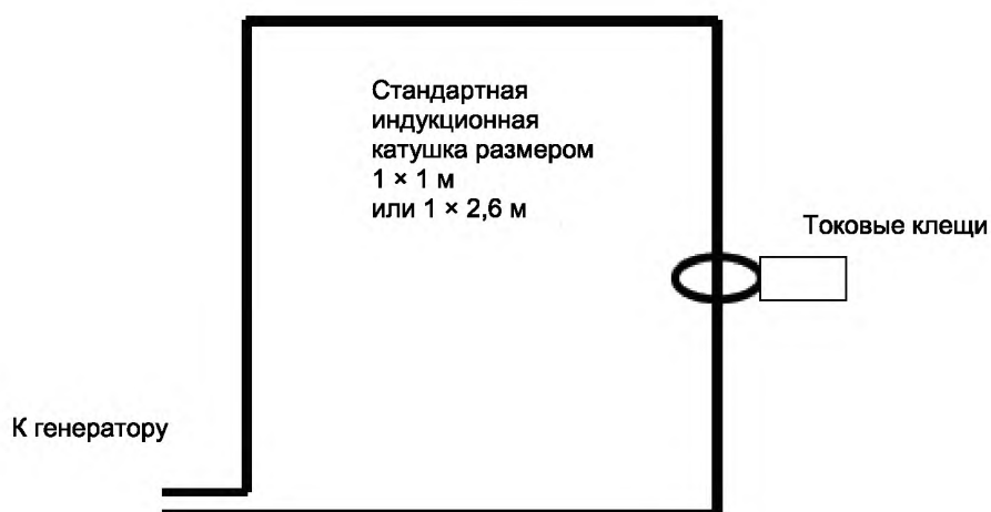
Рисунок 4 – Калибровка стандартной катушки
