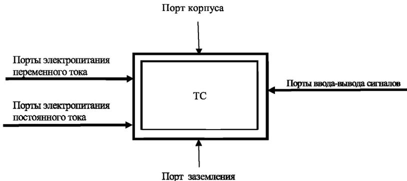
Рисунок 2 — Воздействие электромагнитных помех на порты ТС
