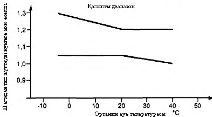
7-сурет - Уақыт төзімі бар өтелген артық жүктемелі релеге арналған қоршаған ауа температурасынан белгіленген мәні еселігі шектерінің тәуелділіктері (8.2.1.5.1 қараңыз)
