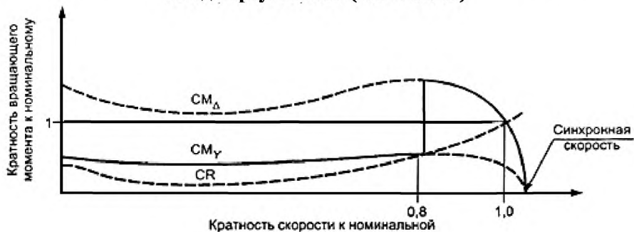
Рисунок 1 - Типичные кривые тока и вращающего момента при пуске по схеме звезда-треугольник (см. 1.1.2.2.1)
