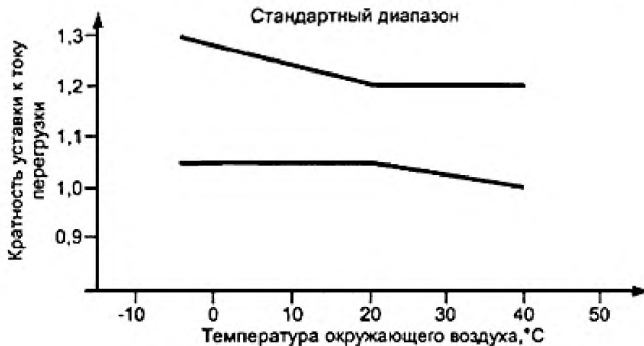
Рисунок 7 - Зависимости пределов кратности уставок тока от температуры окружающего воздуха для компенсированных реле перегрузки с выдержкой времени (см. 8.2.1.5.1)
