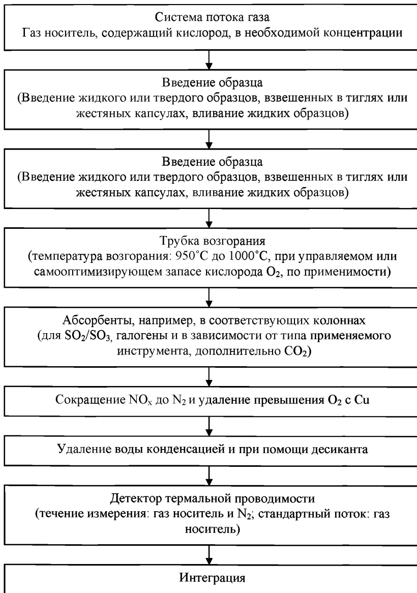
Рисунок А. 1 - Блок-схема базовой конструкции аппарата Дюмаса
