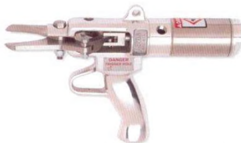
Рис. 2.165. Секатор с пневматическим приводом для отрезания лапок и шей у кур, идеек, уток, гусей
