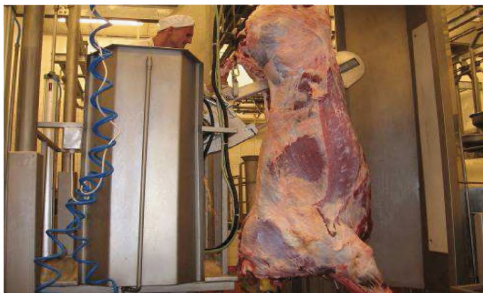
Рис. 2.113. Подъемно-опускная площадка для распиловки туш
