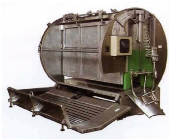
Рис. 2.9. Автоматизировано-механизированная установка поворотного типа
