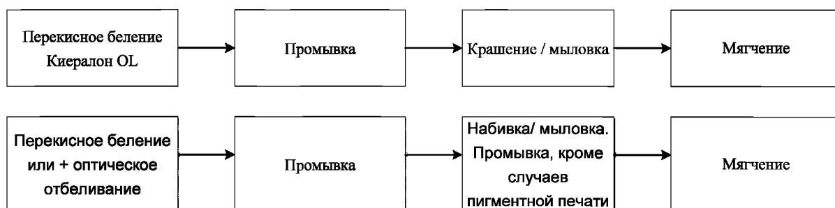
Технологическая схема получения напечатанного хлопчатобумажного и хлопкополиэфирного трикотажного полотна
