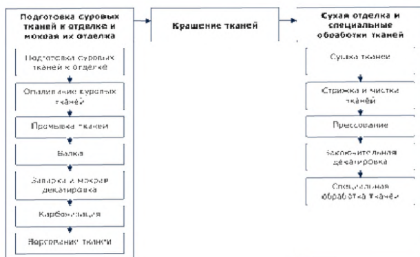
Рисунок 1.13 — Элементы ЦТП отделки шерстяных тканей
