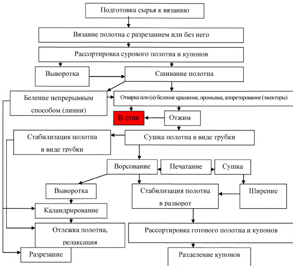
Рисунок 1.9 — Схема технологического процесса производства кругловязаного полотна и купонов
