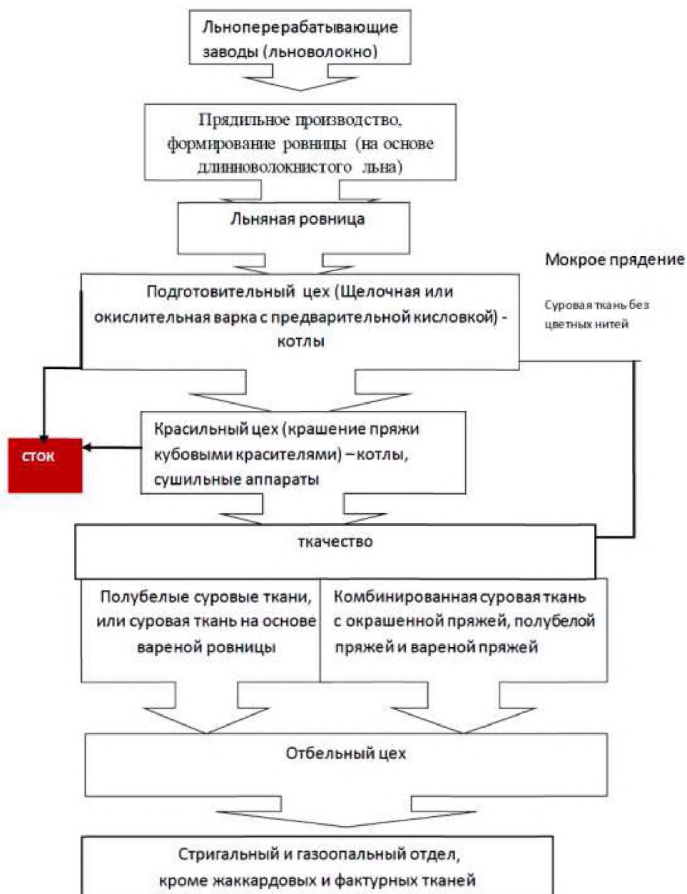
Рисунок 1.8 — Общая технологическая схема производства льняных тканей в системе льнокомбината
