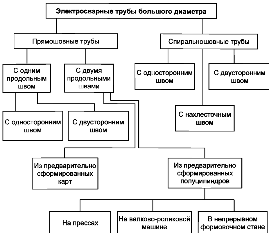
Рисунок 2.44 – Способы производства сварных труб большого диаметра
