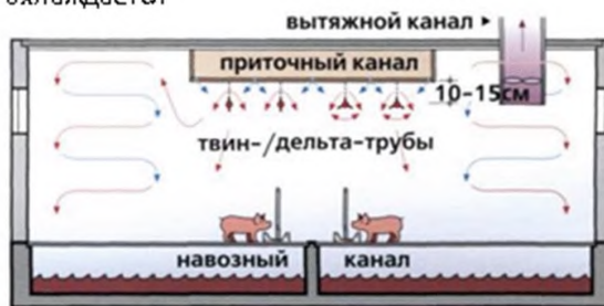
Рисунок 2.46 Если дельта и твин-трубы подвешиваются под приточным каналом, то холодный воздух в помещении быстро нагревается. Однако часть уже теплого воздуха вытягивается наружу и теряется.
