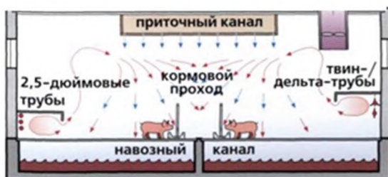
Рисунок 2.45 Если над дельта или твин-трубами устанавливаются навесы, то в логове поросят удастся создать комфортный микроклимат.
