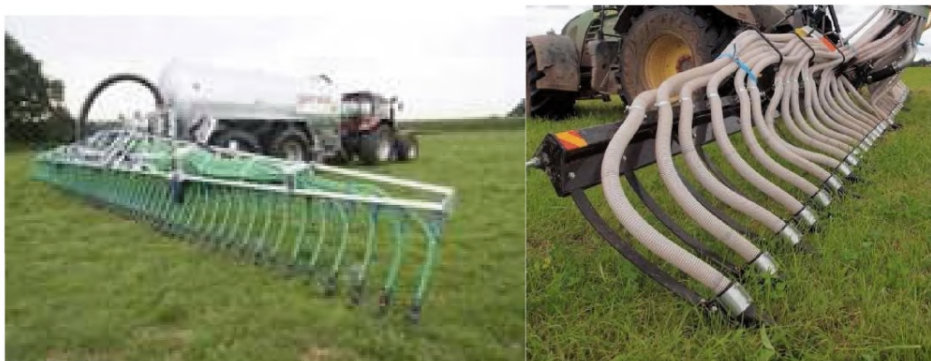
Рисунок 2.73 — Поверхностное внесение жидкого органического удобрения через распределитель с башмачной системой навесных шлангов [61]
