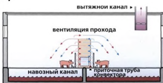
Рисунок 2.43 – Равномерное распределение теплого воздуха обеспечивается только в том случае, если теплогенератор нагнетает его под углом.
