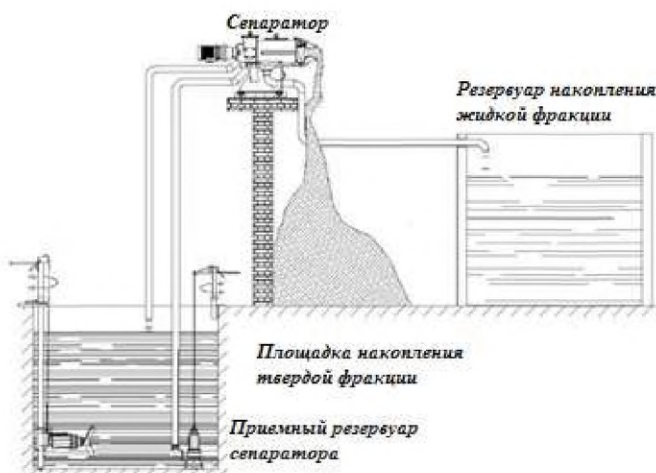
Рисунок 2.65 — Схема разделения свиного навоза на фракции
