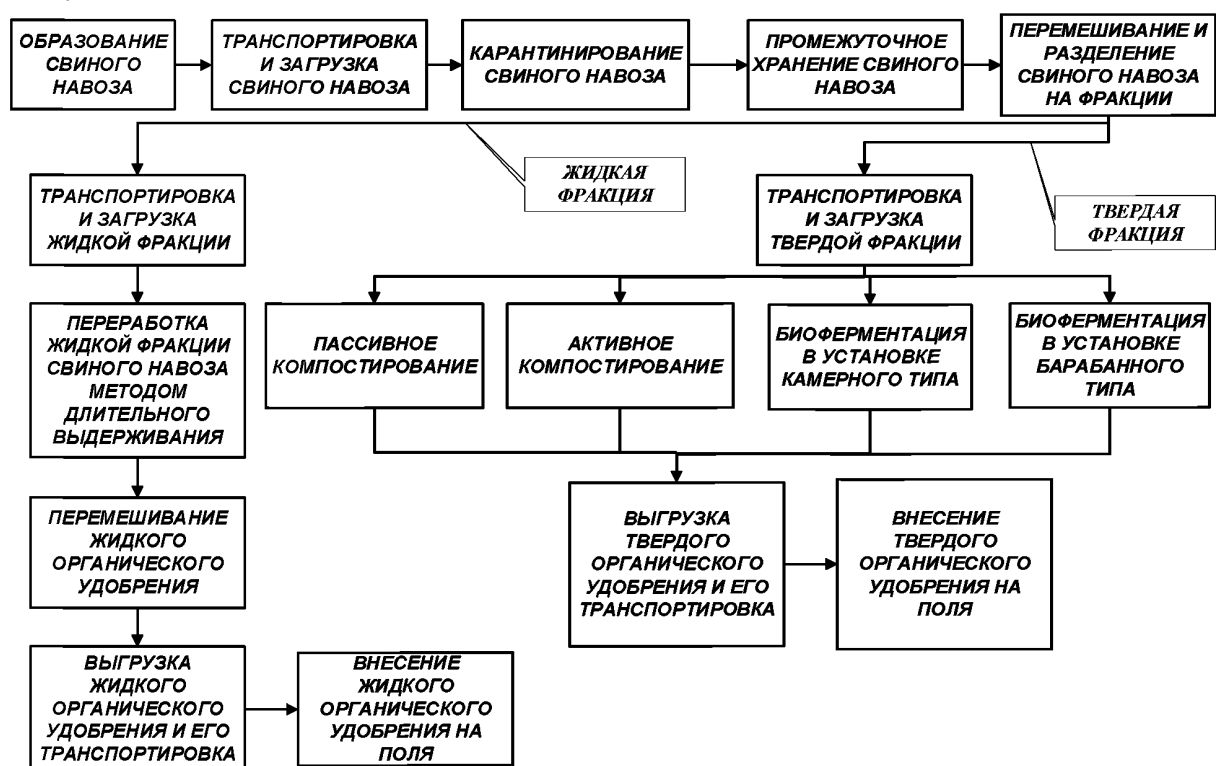
Рисунок 2.63 — Блок-схема технологии переработки свиного навоза в органическое удобрение с разделением на твердую и жидкую фракции
