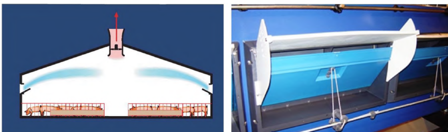
Рисунок 2.29 — Пример системы вентиляции с приточными клапанами
