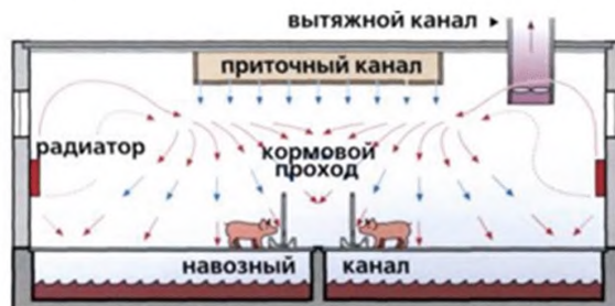
Рисунок 2.44 – При использовании радиаторов теплый воздух поднимается сначала вверх, а там он довольно быстро охлаждается.
