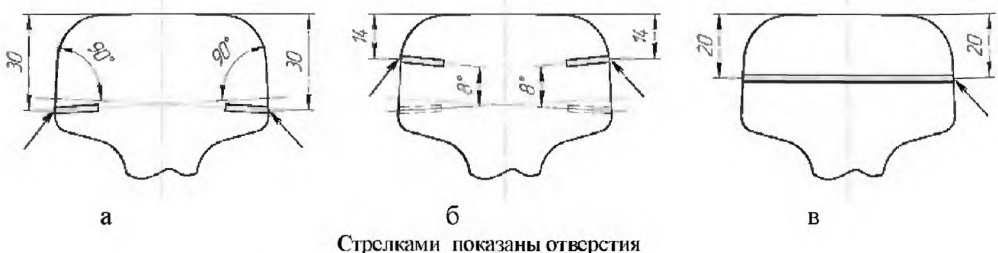
Рисунок И.3 - Расположение отражателей в головке образца
