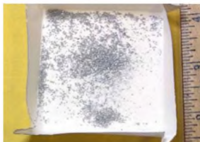
Рисунок Е.12 — Материал шариков припоя, собранный из корпуса BGA посредством процедуры удаления вручную
