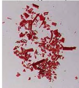
Рисунок Е.9с — Корпус ИМС после разделения
