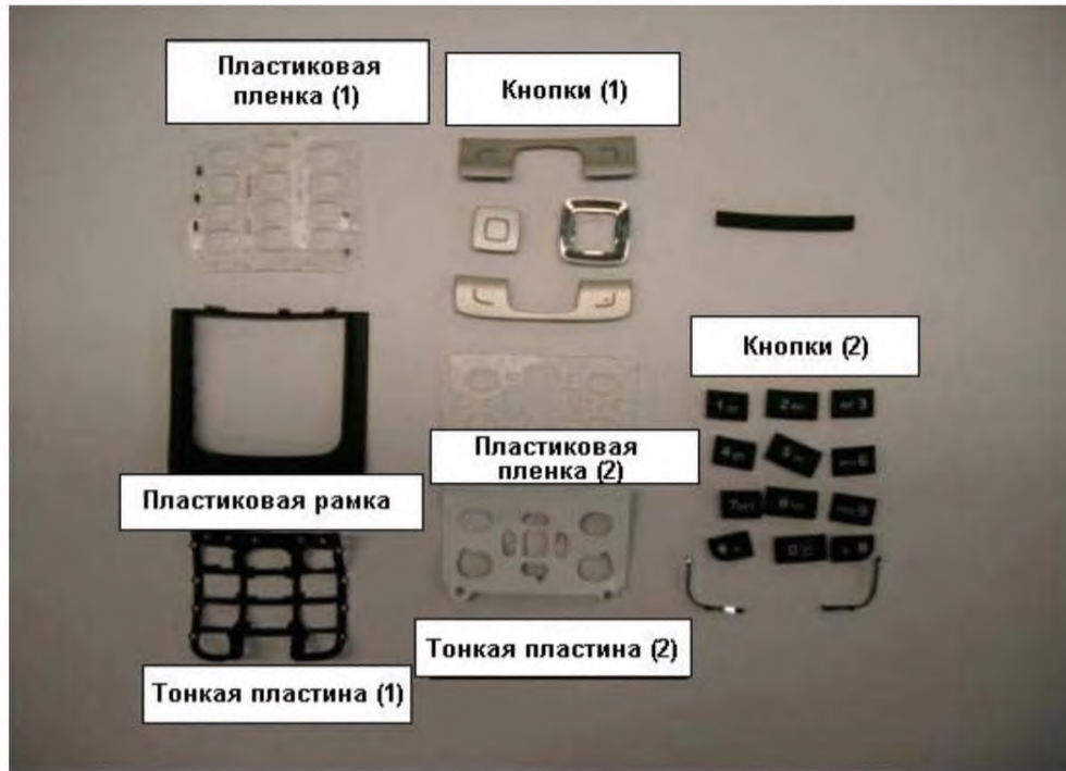
Рисунок Е.4 — Полная разборка клавиатуры
