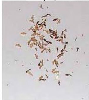
Рисунок Е.9b — Металлические выводы после разделения
