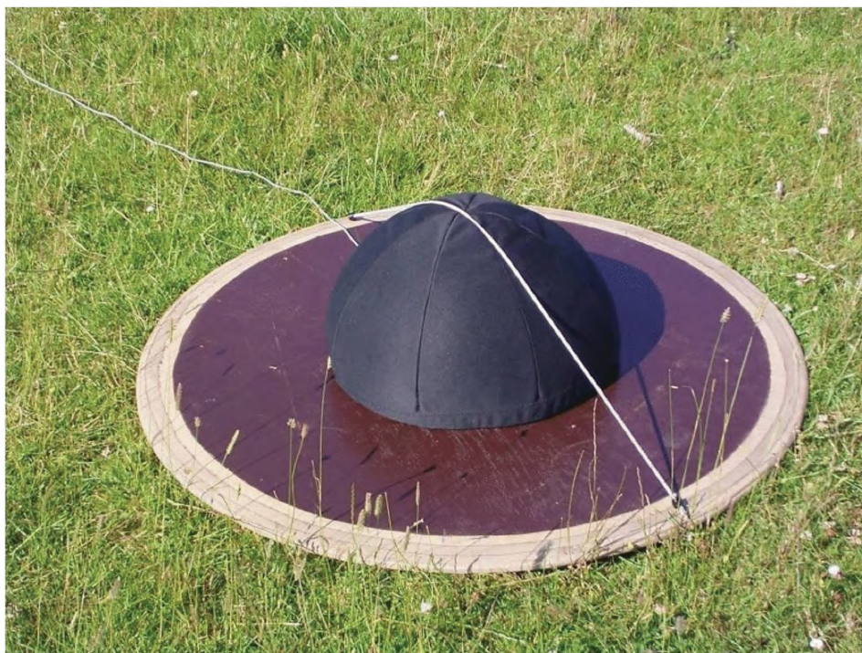
Рисунок С.3 — Дополнительный ветрозащитный экран (вариант 2)
