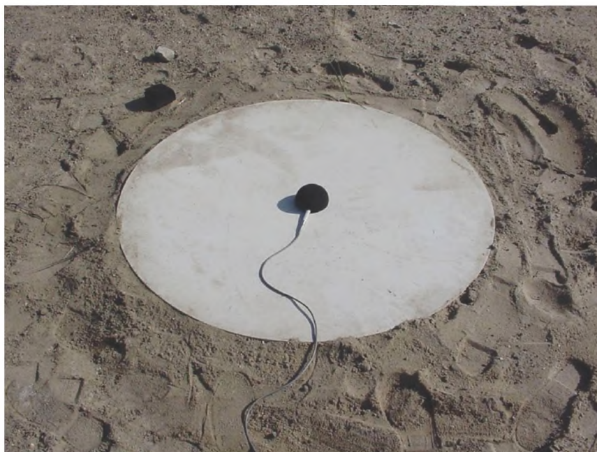
Рисунок 2 — Микрофон, установленный на измерительной панели
