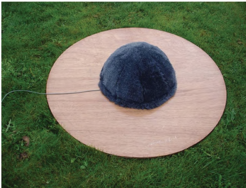
Рисунок С.2 — Дополнительный ветрозащитный экран (вариант 1)
