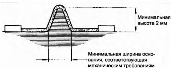
Рисунок F.1 – Измерение ребер
