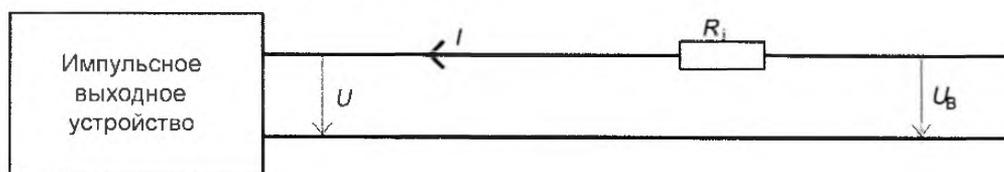
Рисунок Е.2 – Испытательная схема импульсного выходного устройства
