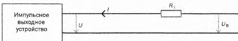
**Рисунок С.1 – Испытательная схема импульсного выходного устройства**
