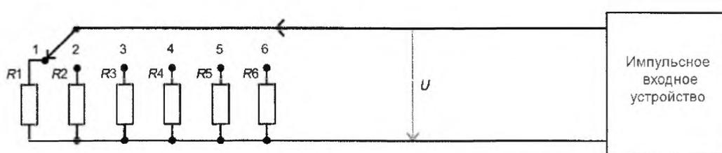
Рисунок Е.3 – Испытательная схема импульсного входного устройства
