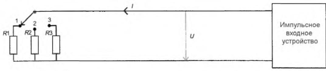
**Рисунок D.1 – Испытательная схема импульсного входного устройства**
