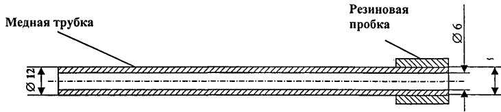
Эскиз пробоотборной трубки
