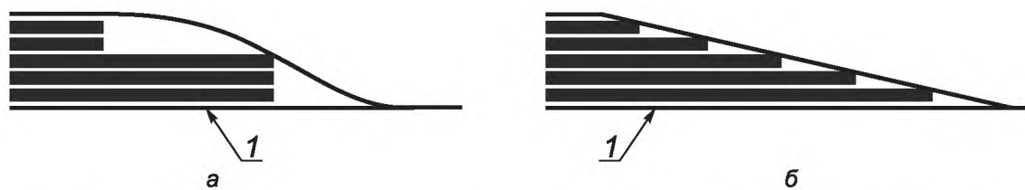
Рисунок А.4 — Рекондуемая конфигурация границы между металлическими накладками и образцом
