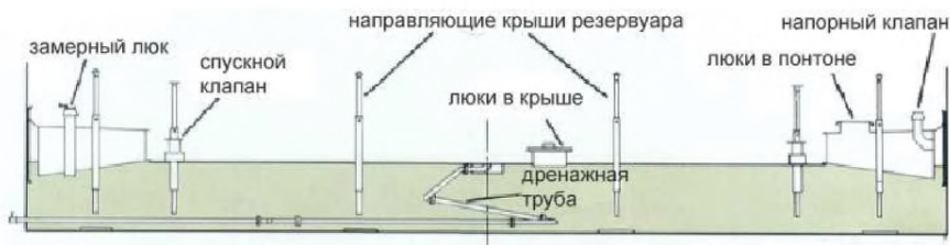
Рисунок 2 – Пример типичной плавающей понтонной крыши
