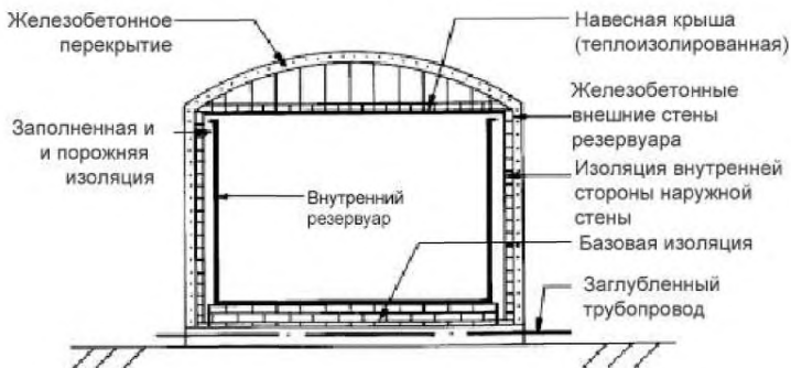
Рисунок 11 – Резервуар с полной защитной оболочкой
