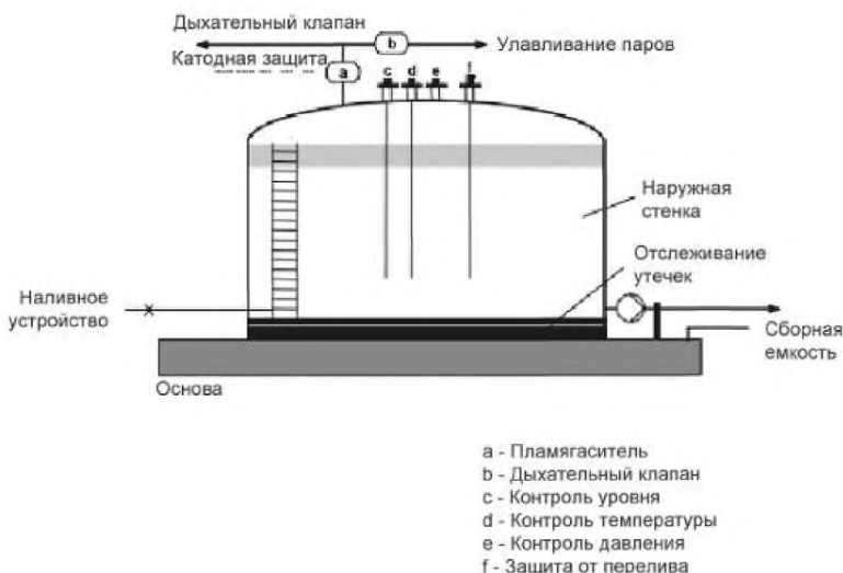
Рисунок 4 – Типичный (вертикальный) резервуар с неподвижной крышей, оснащенный некоторыми устройствами для улавливания выбросов, сбросов
