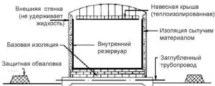
Рисунок 9 – Резервуар с одинарной стенкой
