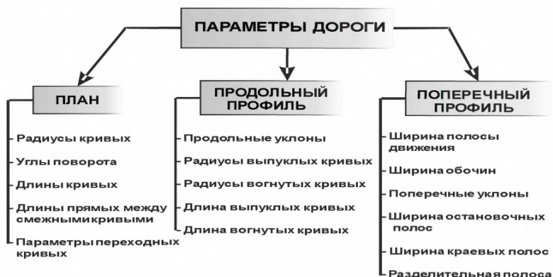
Рисунок 1 – Элементы плана и профиля дороги, требующие оценки при аудите БДД
