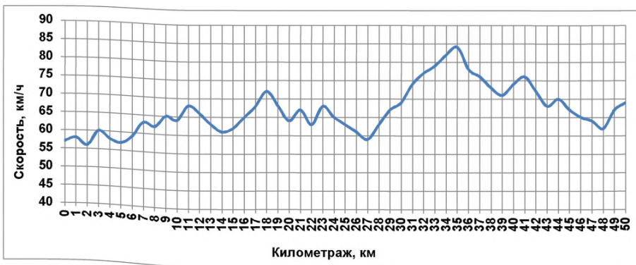
Рисунок 23 – Пример эпюры эксплуатационных скоростей движения
