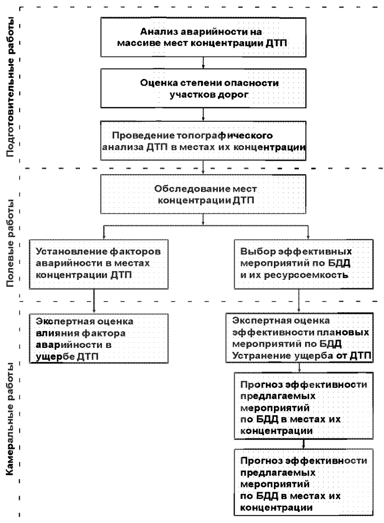
Рисунок 25 – Общий алгоритм проведения работ по аудиту мест концентрации ДТП
