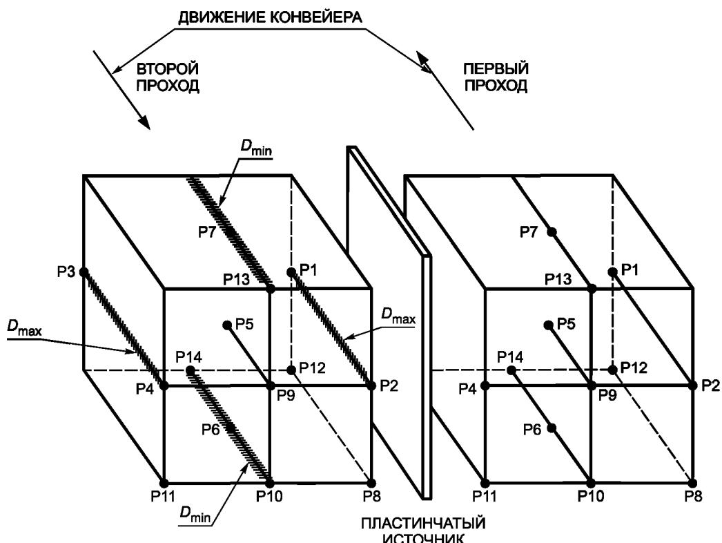
**П р и м е ч а н и е** — Два прохода прямоугольной технологической загрузки, по одному с каждой стороны стационарного пластинчатого гамма-источника. Штриховкой показаны вероятные области максимальной и минимальной поглощенных доз после второго прохода. Буквами Р (с номерами) показаны положения дозиметров, которые могли бы использоваться для картирования поглощенной дозы в процессе оценки операционного качества.
