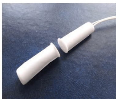
Рисунок 3. Магнитоcontactный извещатель для скрытого монтажа на конструкциях, выполненных из немагнитных материалов.
