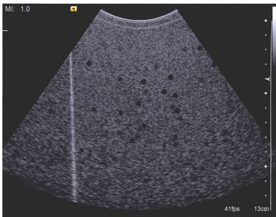
Рисунок В.1 — Изображение образца фантома со слабоотражающими сферами диаметром 4 мм для использования в диапазоне частот от 2 до 7 МГц, полученное с помощью датчика с конвексной решеткой
