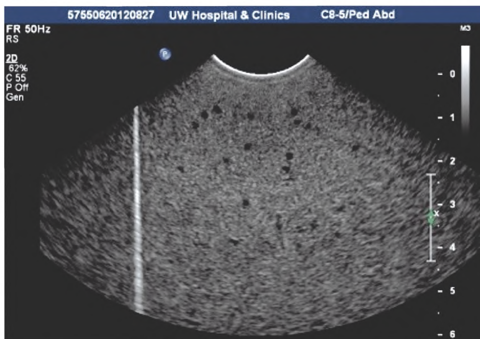
Рисунок С.8 — Изображение фантома, включающего слабоотражающие сферы диаметром 2 мм, полученное с помощью датчика с конвексной решеткой с радиусом кривизны 1,5 см и фокусным расстоянием 3 см
