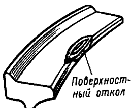
Рис. 3.3. Поверхностный откол наружной грани обода колеса
