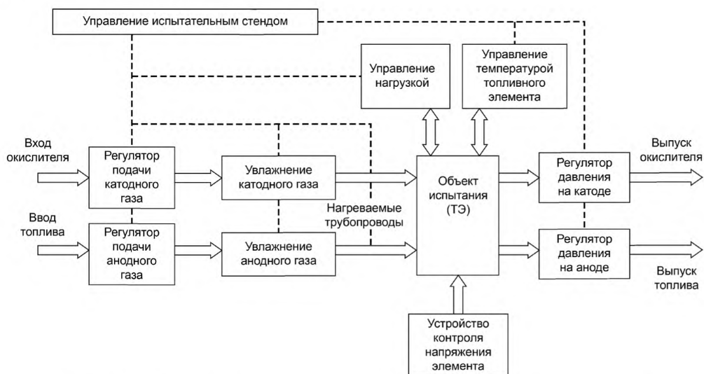
Рисунок 1 — Принципиальная схема стенда для испытания единичного элемента
