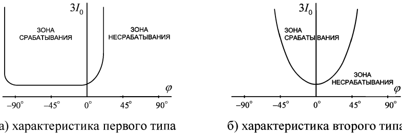
Рисунок В.2 – Фазовые характеристики направленных токовых защит от ОЗЗ, применяемых в сети с резистивным заземлением нейтрали
