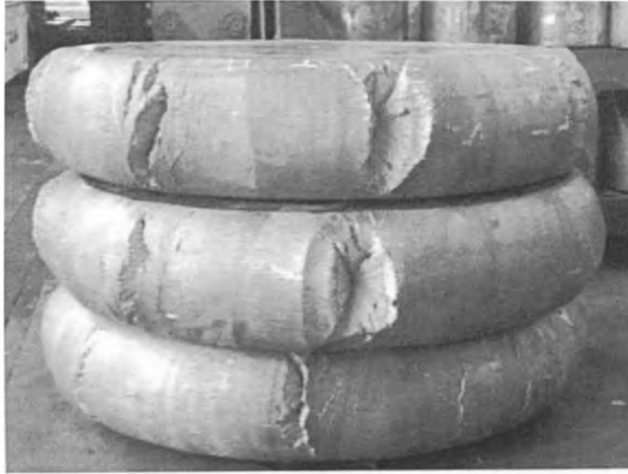
Трещина на поковке
