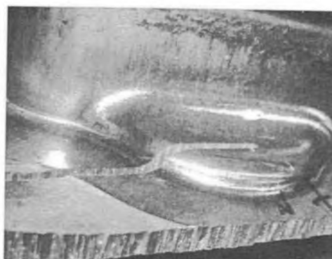
Зарезы на окончательных штамповках
