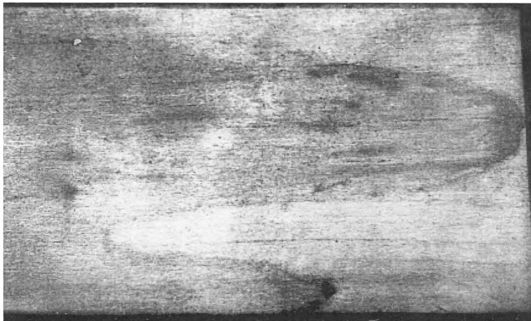
Рисунок А.29 — Пятна закалочные
